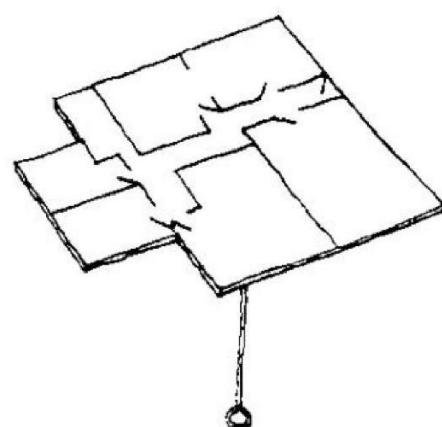
Hình 2-12: Phương pháp trọng tâm tìm trung tâm mặt bằng.
