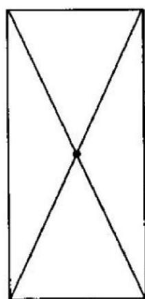
Hình 2-9: Trung tâm mặt bằng hình chữ nhật.
